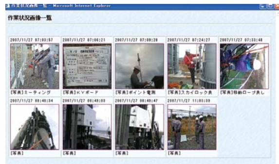
携帯電話カメラ機能を利用してリアルタイムで作業の進捗状況について関係者が確認できる(IT活用)
